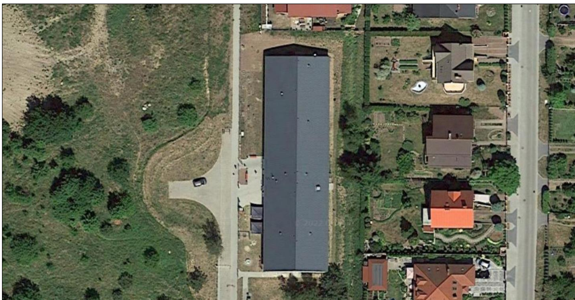
Rys. 27 Widok satelitalny połaci dachowych GP w Straszynie predestynowanych do zabudowy modułami fotowoltaicznymi.
