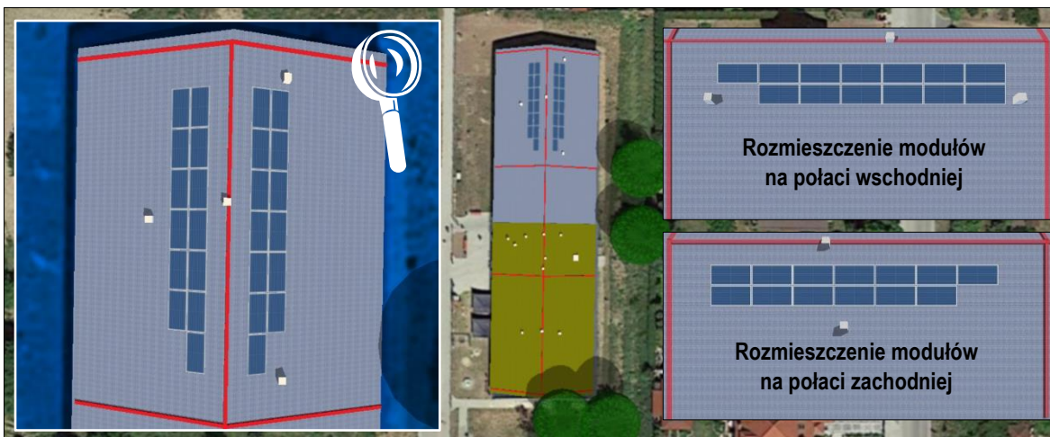
Rys. 29 Propozycja zakresu prac w ramach zamierzenia w obrębie połaci dachowych Gminnego Przedszkola w Straszynie.
